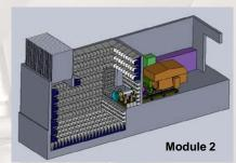
Le deuxième module se concentre sur les instabilités en liaison avec la présence du fluide. Ce banc représentatif d'un fan à l'échelle 1/3 permettra de développer des approches « multi-physiques » et « multi-échelles » où le couplage des physiques joue un rôle central. Ces
