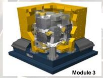
Le troisième module s'attache à étudier la dynamique des machines tournantes embarquées sur un système d'excitation à 6 axes. Il s'agit de prévoir le comportement dynamique en régime stationnaire et transitoire et d'être capable d'en contrôler la stabilité par des voies
