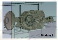
Un premier module compose cette plateforme qui a pour objectif de réaliser des essais vibratoires sous vide dans un contexte de laboratoire. Ces essais à l'échelle d'un moteur aéronautique permettront de couvrir deux champs scientifiques. Le premier
